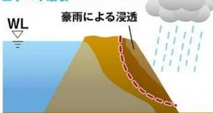
貯留した水と降雨が堤体の中に浸透して、堤体内部の水分量が増加し、堤体の方面部の強度が低下することによって、方面部ですべりが発生し破壊する場合がある。
